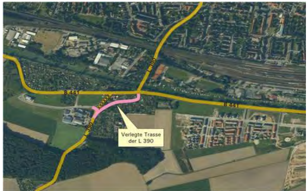
Abb. 7 Trassenüberlegung zur Neustrukturierung des Knotenpunktbereiches B 441/L 390
